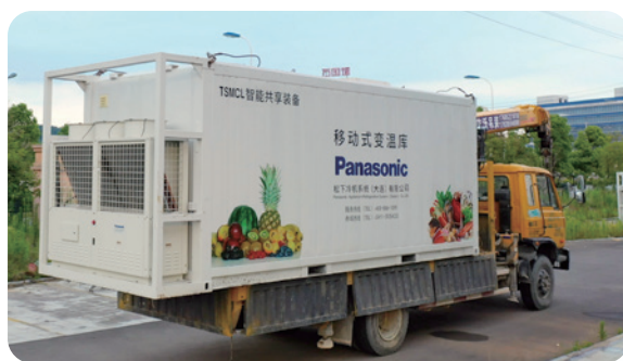
设备方案：移动式预冷保鲜、速冻集装箱产品
