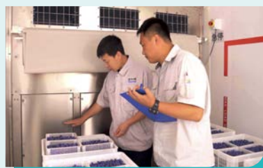
蓝莓在移动式压差预冷箱中进行预冷
