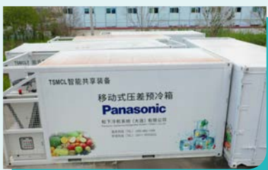
移动式压差预冷箱，用于农产品采摘后快速预冷
